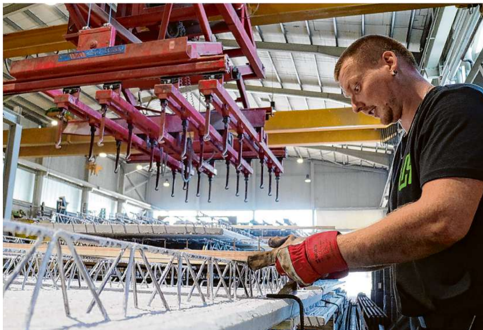
Bauteil für Tesla-Fabrik: Filigrandecken bestehen aus Beton und einer Metallkonstruktion, die dem Beton Tragfähigkeit verleiht. Steffen Reimer arbeitet in der Fertigung dieser Bauelemente.
