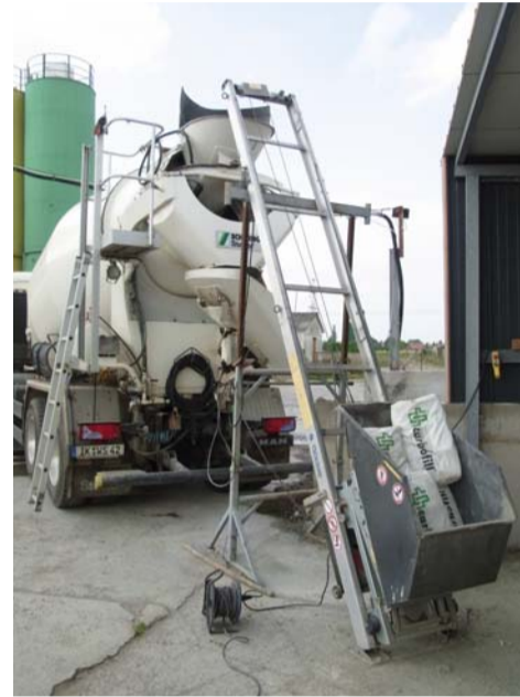
Beladung eines Fahrmischers mit carbofill® S in wasserlöslichen Papiersäcken (th-beton Stotternheim)
